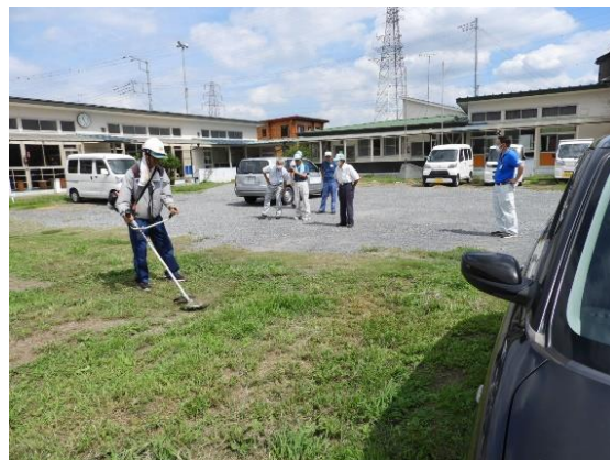
石が飛ばないカルマー刃草刈機の実証
